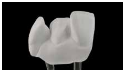
Fig. 8: Ponte in zirconia bianca dopo la fresatura
