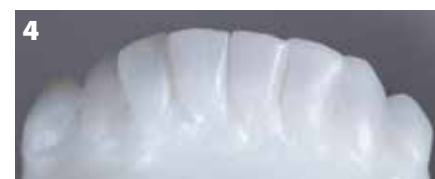
Fig. 4: Después de la sinterización: aumento de la translucidez aparente de las zonas incisales
