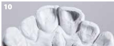
**Fig. 10 :** Avant frittage : sous-structure monolithique en zircone avec cut-back lingual
